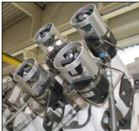
Złożenie głowicy napinacza 4 x BTC typ ES 36- 10.9 z bezpośrednim systemem PSD (System cyfrowej dokumentacji naprężenia).
